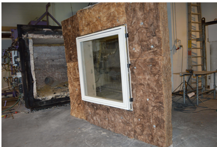
Færdig monteret BS-Falsen 2009 med et standard termo vindues element
