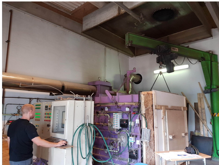
Test start Vindue er afdækket for ikke at få ild ud i testlokalet. Glasset springer efter 3 min.
